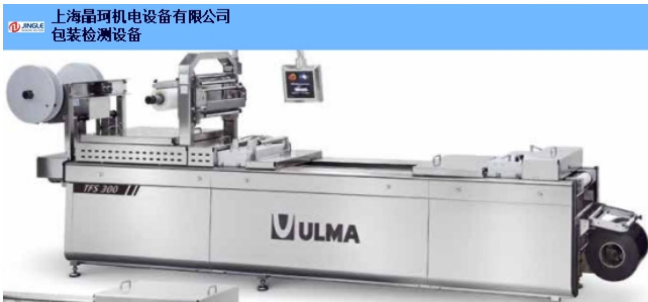
上海晶珂机电销售的拉伸膜包装机能自动识别纸盘尺寸或手动。自动或手动选择膜的长度和宽度。自我诊断能力。薄膜张力控制。转发和保留点动功能。4向薄膜拉伸与横向预拉伸。密封带的温度控制。超大包装检测器。机械扭矩限制器。防护装置和安全装置符合国际标准。采用耐腐蚀材料的重型结构。这些机器提供了经济的解决方案，并具有与大型热成型机器相同的节省成本的优点：降低包装成本。提高生产力。改善产品外观。产品加载速度更快。机器的特性使其非常适合混合生产要求，因为可以轻松更改格式以满足客户的需求。它的多功能性，简便的操作和快速的尺寸更改也使其非常适合用作短期产品的支撑机器。天津火腿拉伸膜包装机热成型拉伸膜包装机—拉伸膜气调包装机—全自动贴体包装机销售厂家上海晶珂。
